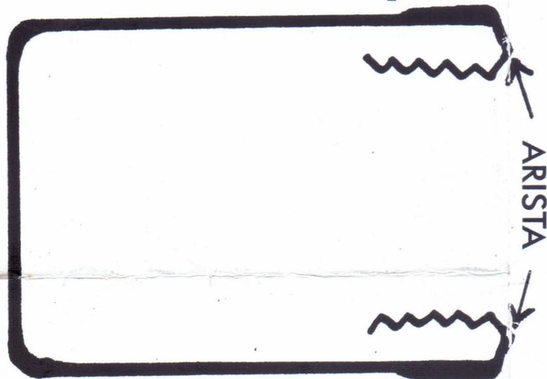
PARA SACAR EL RESIDUO DEL CARBURO (HIDROXIDO DE CALCIO) **NUNCA PICAR EL DEPÓSITO** Y MENOS **SOBRE PIEDRA O SUPERFICIES DURAS**, PUES LA **ARISTA DE LATÓN** ES MUY
